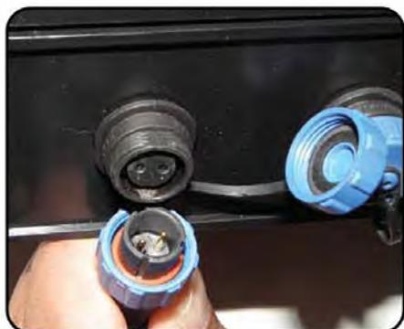
コントロールパネルの3-ピンマイクロXLRコネクタを介したソニハルモニタリング出力。
